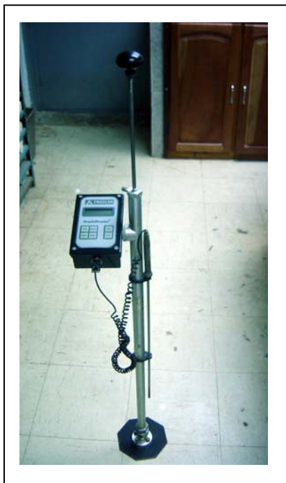
Fotografía N° 16: Equipo Troxler para medir espesores in situ en carpetas de concreto asfáltico
