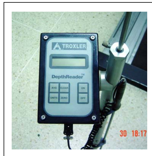
Fotografía N° 17: Detalle del medidor de espesores Troxler con termopar incorporado.
