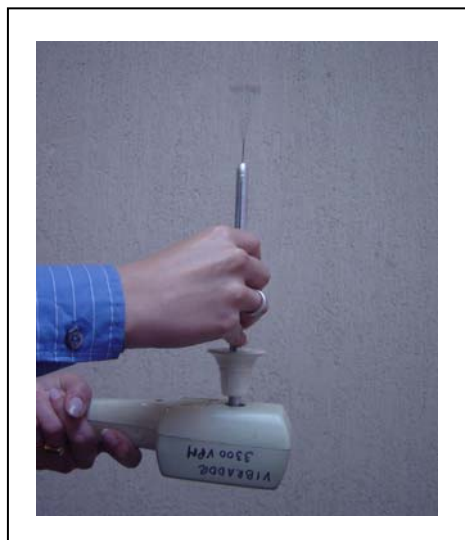
Fotografía N° 3: Fenómeno de resonancia
